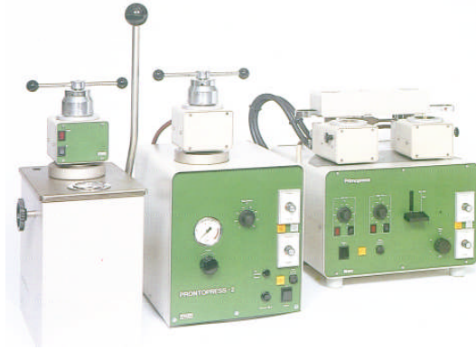
Resim 2.3: Isıtma ve soğutma sistemli kapalı devreli presler
